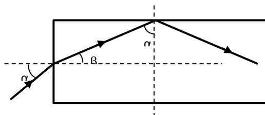
Максимальное значение угла  $\alpha_1$  падения луча на торцевую поверхность световода будет соответствовать максимально возможному значению угла преломления  $\beta_1$ , причем  $\frac{\sin \alpha_1}{\sin \beta_1} = n$ . Тогда  $\sin \beta_1 = \cos \alpha_2 = \frac{1}{n} \sin \alpha_1$ . Следовательно,
