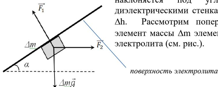
На элемент  $\Delta m$  действуют три силы: сила тяжести  $\Delta mg$ , сила Ампера  $F_2$  и сила реакции нижележащих слоев электролита  $F_1$ .
