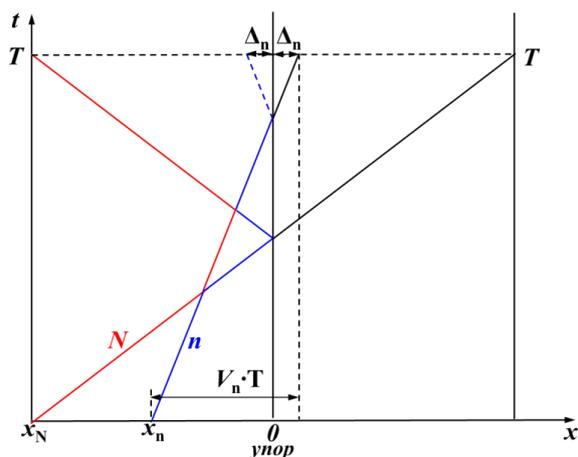
Построим графики движения всех вагонов на диаграмме («время» - «координата»), т.е.  $(t-x)$ . Эти графики для каждого вагона между столкновениями представляют собой прямые линии (движение прямолинейное, равномерное). В процессе столкновения происходит обмен скоростями, так что графики после столкновения продолжают те же прямые линии, происходит только обмен линиями
