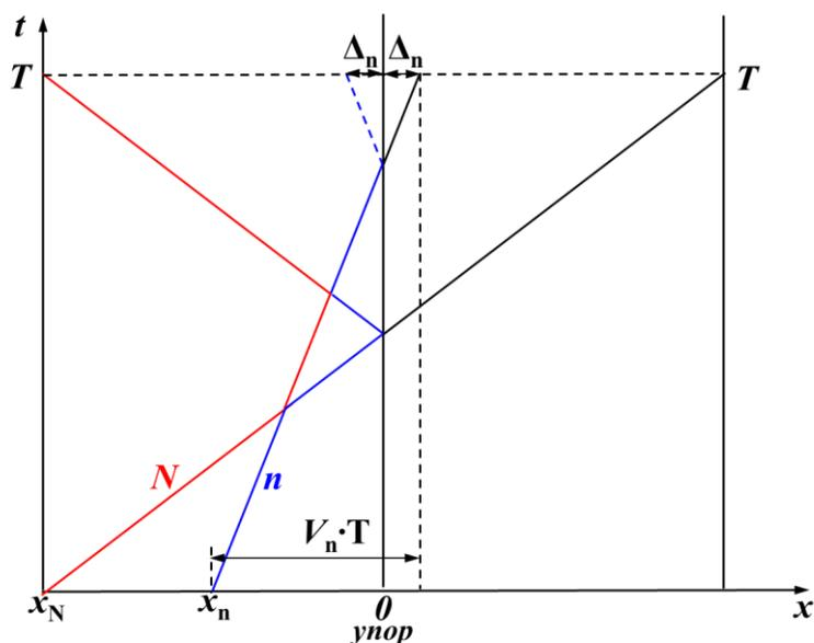
замене, это еще одно пересечение исходных линий (столкновение вагонов), но если обеспечить на финише такую же последовательность вагонов, как и на старте (поскольку реальные вагоны не могут проходить друг сквозь друга), то каждая пара линий (соответствующая каждой паре вагонов) будет иметь пересечение, как показано на рисунке. Самая пологая линия на графике соответствует последнему вагону, скорость движения которого максимальная. По этой линии можно определить время движения
