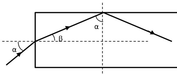
Максимальное значение угла  $\alpha_1$  падения луча на торцевую поверхность световода будет соответствовать максимально возможному значению угла преломления  $\beta_1$ , причем  $\frac{\sin \alpha_1}{\sin \beta_1} = n$ .
