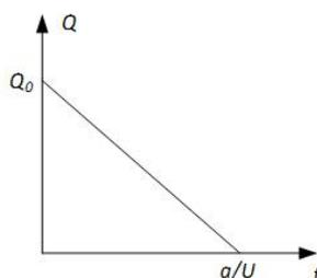
Площадь под графиком имеет смысл полного объема воды, прошедшей через отверстие с начала опускания заслонки
