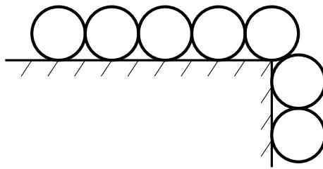
В начальный момент времени связка начинает двигаться под действием собственного веса без начальной скорости. Трение о вертикальную поверхность отсутствует. Всеми процессами, происходящими при переползании шарика с горизонтального участка на вертикальный, пренебрегаем.
